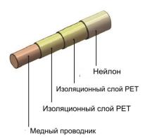
**Провода в тройной изоляции ТІW** имеют три слоя изоляции, что повышает сопротивление изоляции. Не требует дополнительной изоляции между обмотками трансформаторов. Выпускаются трех температурных классов: В- 130С, F-155С и H-180С. Диаметр от 0,15 до 1,00мм с шагом 0,05мм. Единица измерения – метр (километр). На катушке, как правило, 2500м – 3000м в зависимости от диаметра провода. Не требует зачистки при пайке
